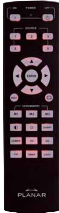
Der Infrarotsender des Planar ist schlicht und funktional. Die Quellen 1-5 sind frei programmierbar und die wichtigsten Bildjustagefunktionen sind per Direktaste aufrufbar. Jeder Tastendruck lässt den Geber in schickem Rot erleuchten
